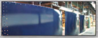
**Etapa 4:** Terminado este proceso las láminas u hojas recubiertas con Vitrium de vidrio glaseado y fusionado al acero son pasadas a rigurosas pruebas de calidad y preparadas para embarque
